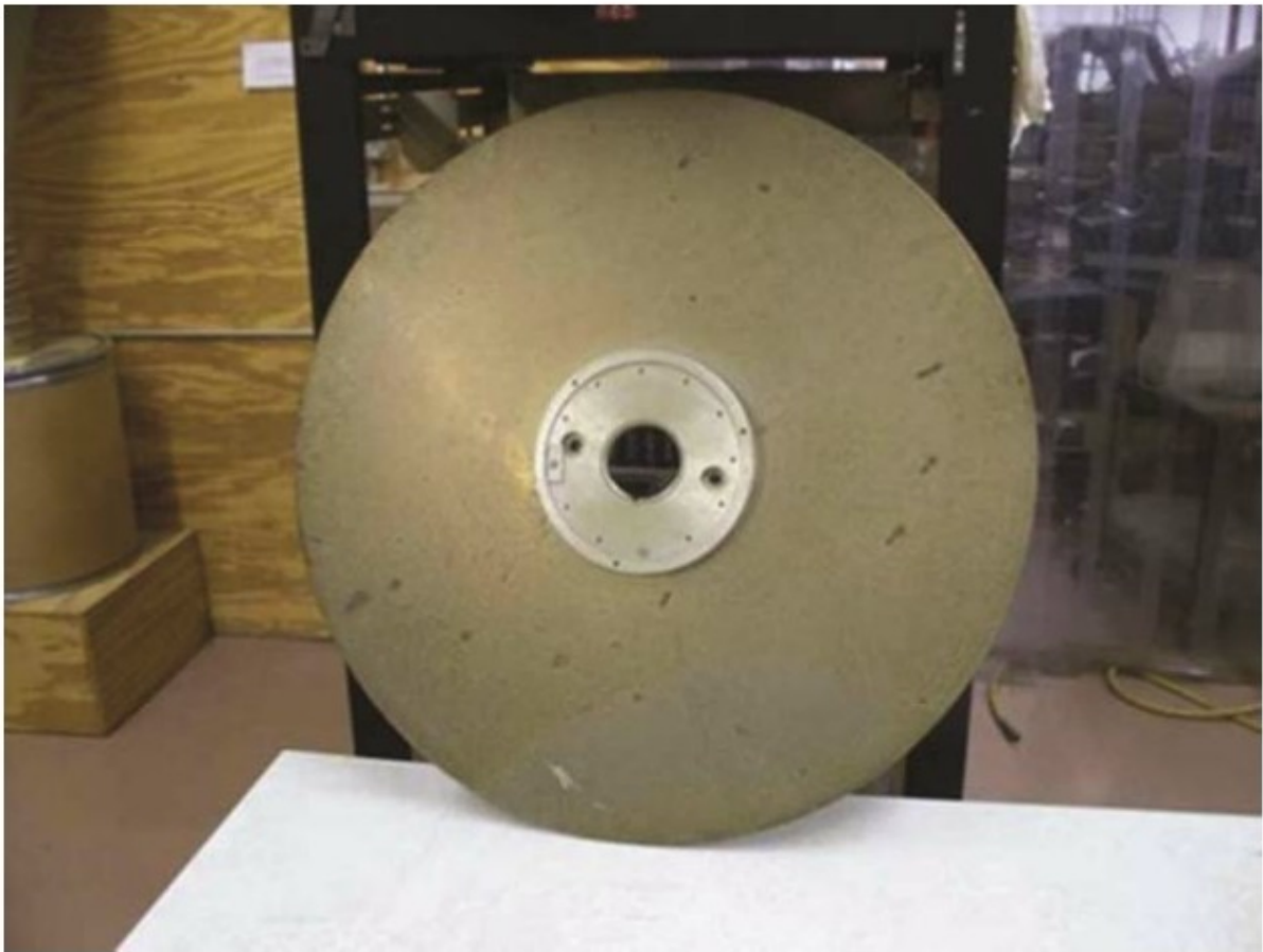
图A.3：硬盘的盘片，3/8英寸厚，直径36英寸
